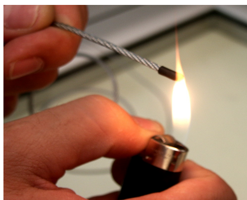
2) Placer la gaine thermo-rétractable et chauffer le bout du câble.
