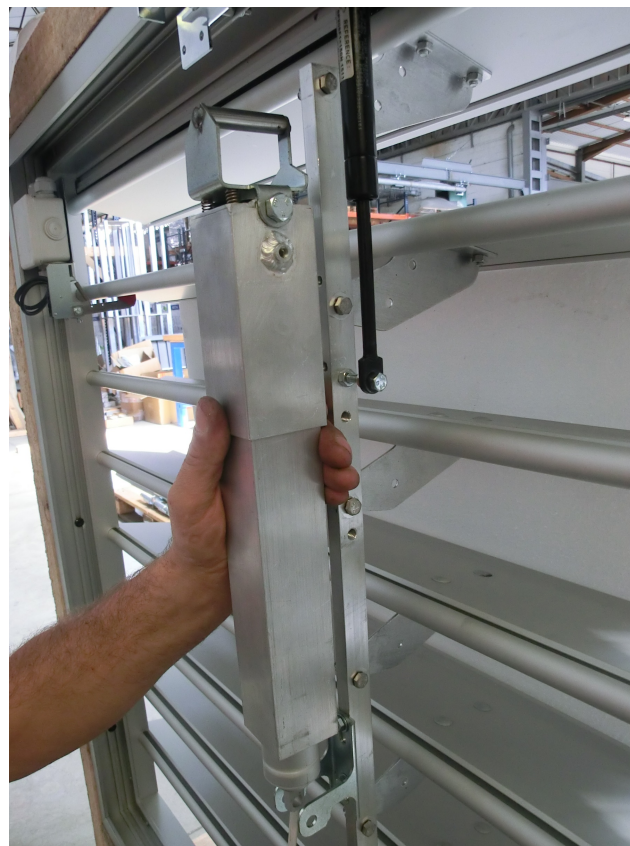
Présenter l'ensemble vérin + gâche et l'axe de la tige du vérin en face du perçage de la patte.
