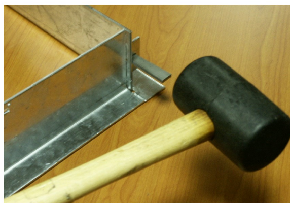
4 – Une fois le cadre constitué, engager les clavettes (au marteau) suivant la figure ci dessus.
