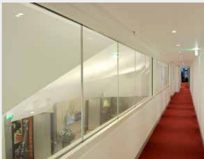
Hôtel des Ventes Drouot - Paris (75) Cloisons vitrées bord à bord EI 90 - © Agence du Rivau
